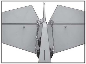
INSTALLING TAIL STRUT SYSTEM.
