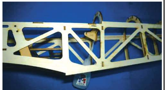
Mit Sekundenkleber befestigen Sie F20.
