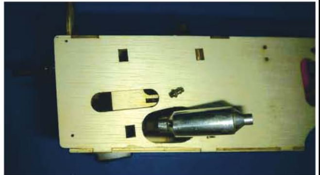
Montieren Sie den Dämpfer.
