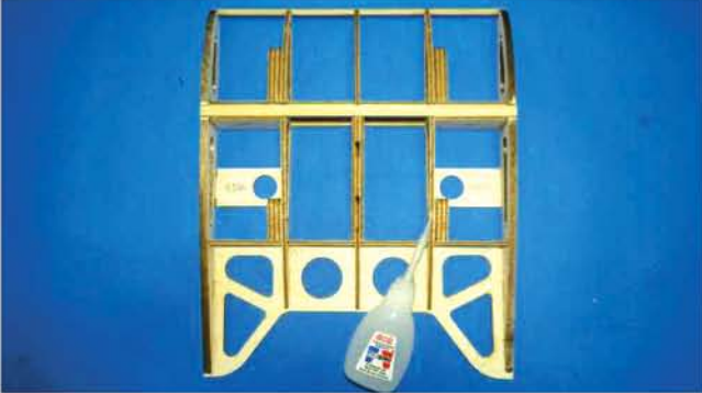
Mit Sekundenkleber befestigen Sie W9, W13 und W11.
