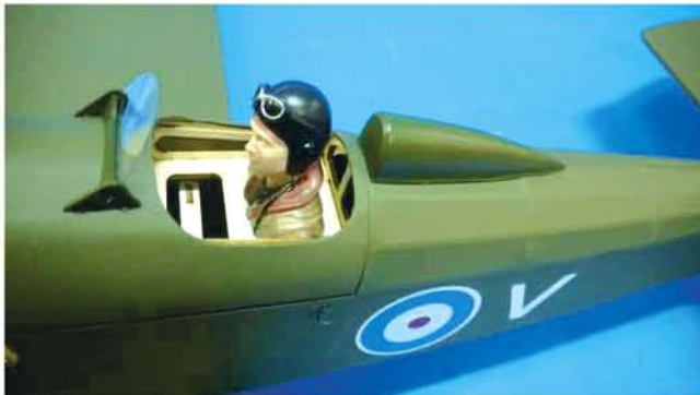
Platzieren Sie das Polster hinter den Piloten.
