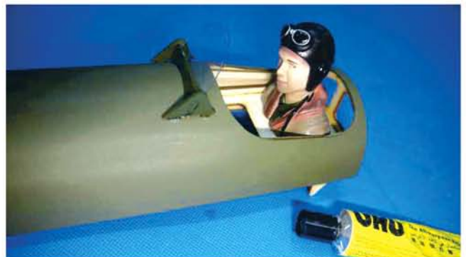
Mit Sekundenkleber befestigen Sie C14 und C15. Dann lackieren. Nach dem beziehen befestigen Sie mit UHU Klebstoff das Fenster.
