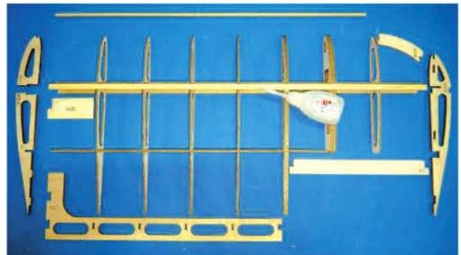
Bereiten Sie W15, W17, W18, W18A, W25, W26, ein Holzstreifen und ein Rundholz vor, und befestigen alles mit Sekundenkleber.
