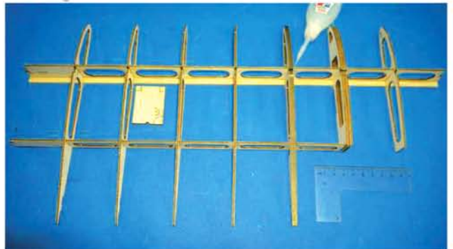
Mit Sekundenkleber befestigen Sie die Flügelrippen an W14. (Vergewissern Sie sich, dass jede Rippe senkrecht steht).
