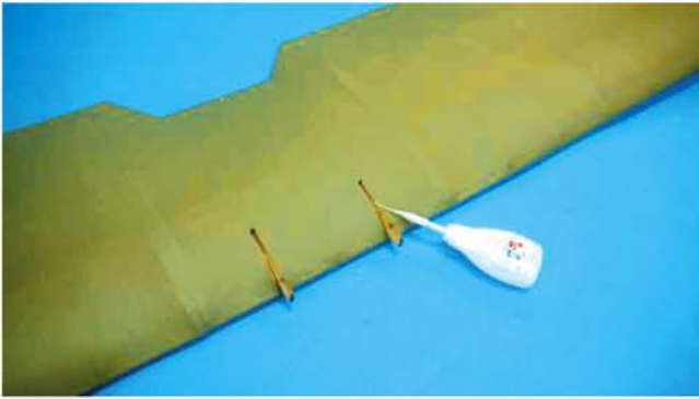
Platzieren Sie zwei DW10 Teile und befestigen diese mit Sekundenkleber.
