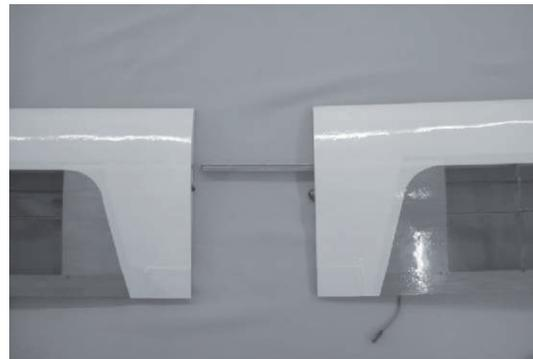
Mischen Sie Epoxid und kleben die Flügelverbinder aus Holz an beiden Seiten des Flügelverbinders aus Metall an. Mit Klammern fixiert warten Sie bis das Epoxid ausgehärtet ist.
