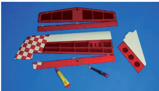
Geben Sie Superkleber auf die Scharniere. Befestigen Sie die Scharniere im Flügel und stecken diesen ans Querruder. Dann sichern Sie alles mit den M 2 x 6 mm Gewindeschrauben. Befestigen Sie die Scharniere am gesamten Heckleitwerk und verkleben das Seitenruder und Höhenruder mit den anderen Hälften der Scharniere. Das Ganze sichern Sie mit M 2 x 5 mm Gewindeschrauben.
