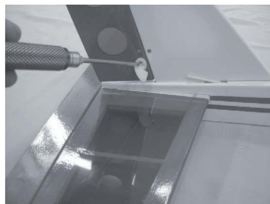
Mit einem 2 mm Bohrer bohren Sie Löcher in das Seitenruder. Sichern Sie das Ruderhorn in diesen Löchern.
