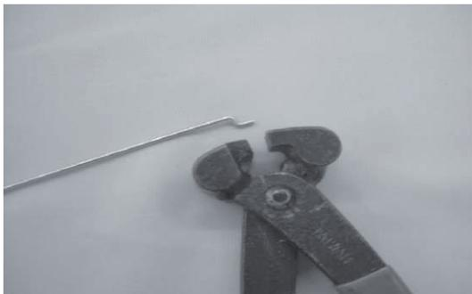
Mit der Z- Zange, biegen Sie die Z- Form am Gestängeende.
