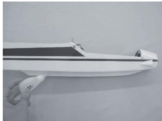
Mit Sekundenkleber befestigen Sie die Kufe an der Rumpfunterseite.
