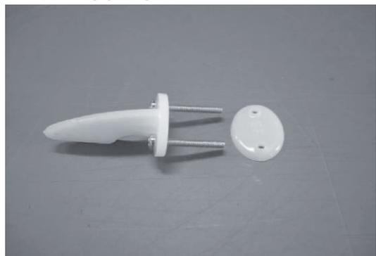
Nehmen Sie das Ruderhorn und die M 2 x 15 mm Schrauben aus dem Zubehörbeutel. Montieren Sie diese, wie auf dem Foto gezeigt. Bitte beachten Sie, dass das Ruderhorn zu der Ruderoberfläche senkrecht steht, wenn dieses befestigt ist.
