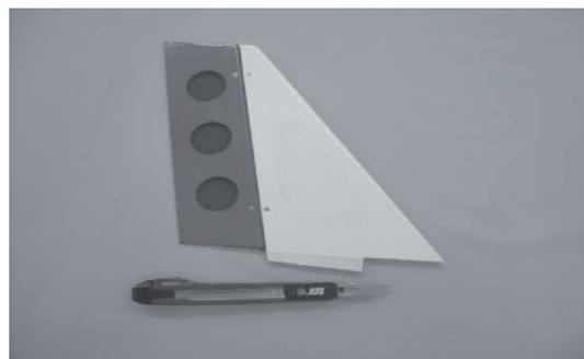
Passen Sie das Seitenleitwerk am Rumpf an. Wenn Sie mit der Ausrichtung zufrieden sind, markieren Sie mit einem Stift beide Seiten des Seitenleitwerks, wo diese in den Rumpf geht. Mit einem Messer scheiden Sie vorsichtig die Folie innerhalb der Markierungslinie weg. Nicht ins Holz schneiden.
