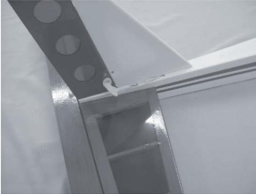
Führen Sie die Gestänge in die äußeren Gestängerohre ein. Befestigen Sie Gabelköpfe an den Ruderhörnern, sowohl für das Höhen- wie für das Seitenruder.
