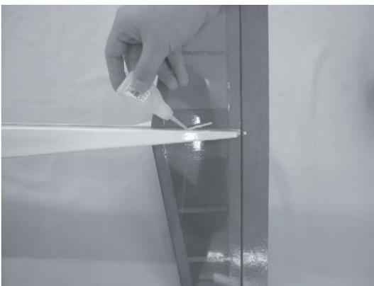
Mit Sekundenkleber fixieren Sie das äußere Gestängerohr für das Rudergestänge an der Rumpfoberseite. Die Länge des äußeren Gestängerohrs ist 25-30 mm kürzer als Gestänge.
