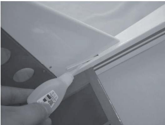
Mit Sekundenkleber fixieren Sie das äußere Gestängerohr für das Rudergestänge an der Rumpfoberseite. Die Länge des äußeren Gestängerohrs ist 25-30 mm kürzer als Gestänge.
