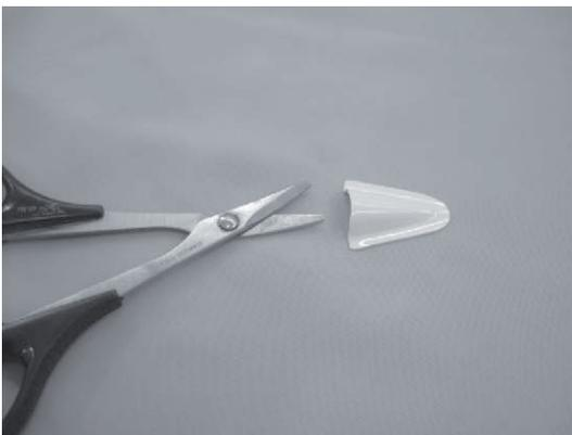
Nehmen Sie zwei Lufteinlässe aus dem Zubehörbeutel. Beschneiden Sie die Kanten, lassen aber 2mm an den Kanten stehen, und schneiden die Öffnungen an den Vorderseiten aus.
