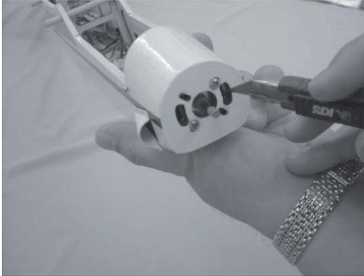
Mit einem Messer schneiden Sie die Folie über den Löchern für die Motorkühlung und Schrauben aus
