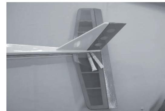
Mit Epoxid bestreichen Sie den Boden des Seitenleitwerks an dem Kontaktpunkt im Rumpf. Schieben Sie das Seitenleitwerk in den Rumpf.
