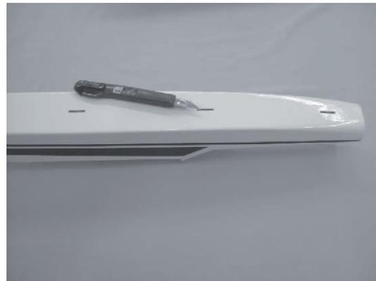
Mit einem Messer schneiden Sie die drei präparierten Schlitzte an der Rumpfunterseite aus.
