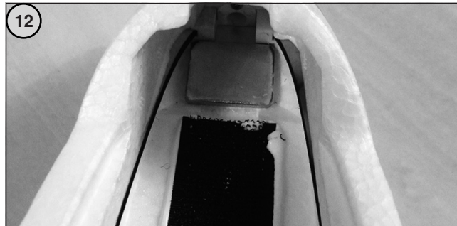
Akku an richtiger Position mit Klettband fixieren
